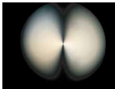
図2 \lambda/2 ローテーターで確認したラジアル偏光ビーム強度分布
